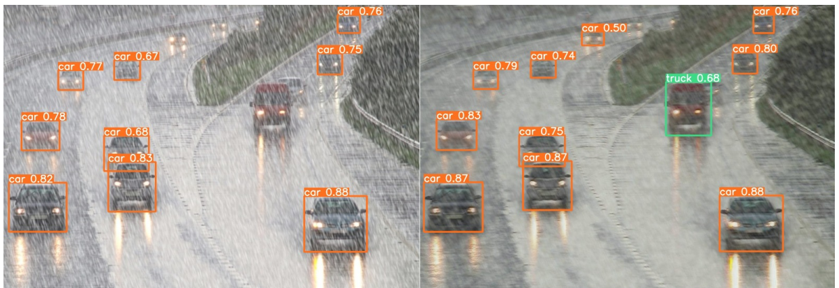
Рисунок 3.2 – Влияние восстановления изображения от дождевых деградаций на результат обнаружения объектов дорожной сцены: слева – исходное изображение с дождевыми артефактами и результат детекции; справа – изображение после восстановления разработанным методом и результат детекции.
