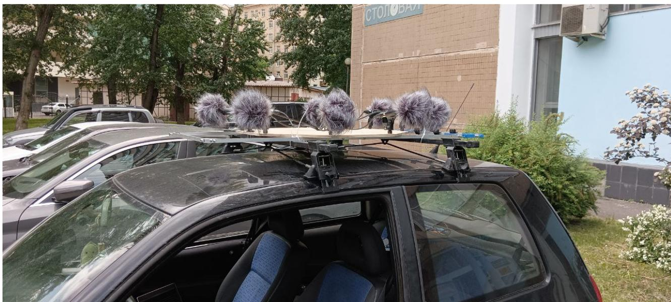
Рисунок 4.5 — Фотография микрофонного массива из 8 микрофонов.
