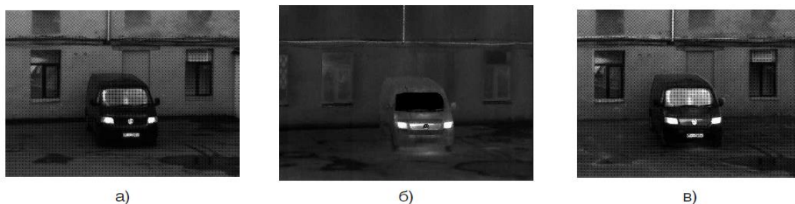
Рисунок 1.5 – Синтезированное изображение автомобиля (в), полученное на основе телевизионного (а) и тепловизионного (б) видеокadres
