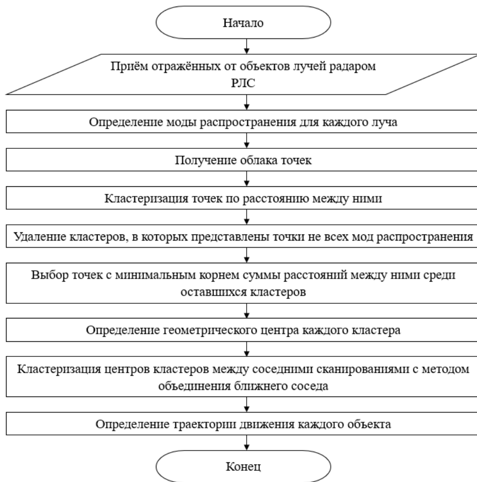
Рисунок 3.15 – Блок-схема алгоритма постобработки радиолокационных данных РЛС для определения траектории объектов
