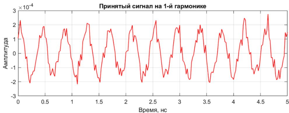
Рисунок 12 – Принятый сигнал на частоте первой гармоники
