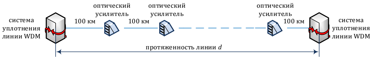
Рисунок 4.1 – Типовая двунаправленная оптическая линия связи
