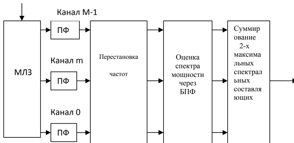
Рис. 3.5 Структурная схема согласованного фильтра для ДЧ сигнала прошедшего двухлучевой канал.
