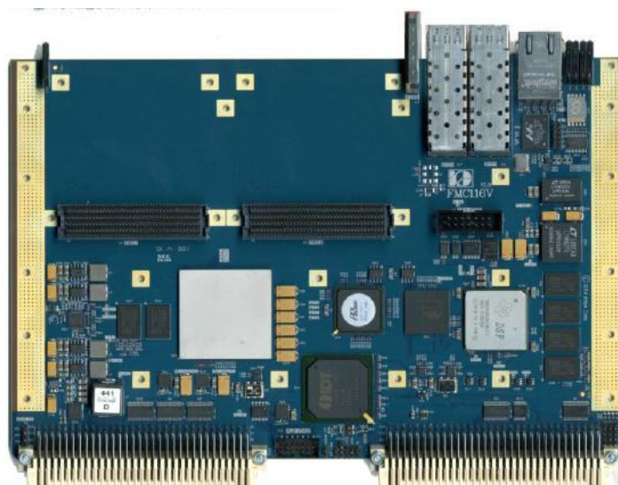
Рис. 5.1 Фото базовой платы FMC116V использованной при создании устройств формирования и приема СКК на основе турбо-подобных кодов и дискретных частотных сигналов.
