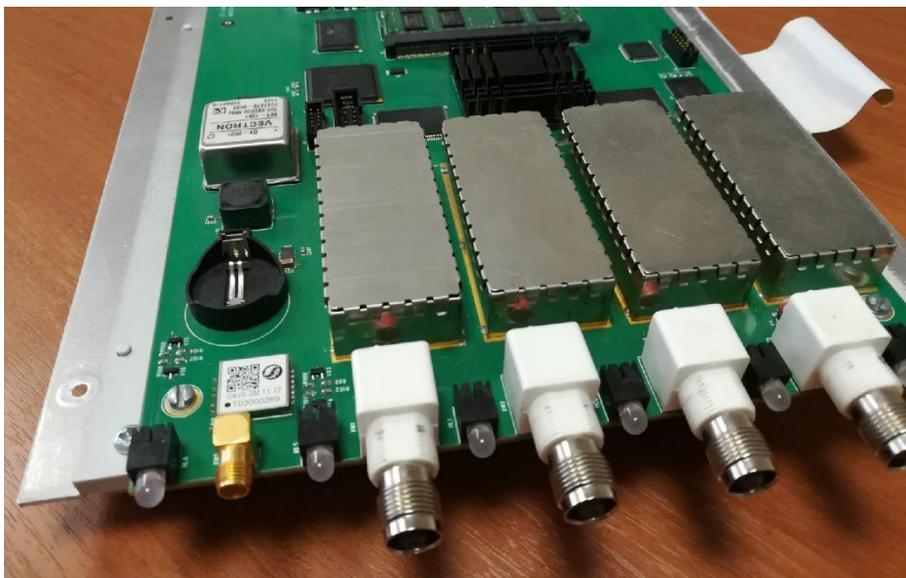
Рисунок 4.5 - Плата приемника «Морошка»
