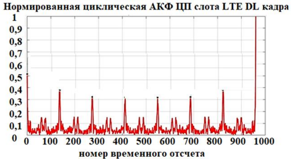
Рисунок 2.2 – Модуль нормированной циклической АКФ ЦП 7 символов OFDM слота кадра LTE
