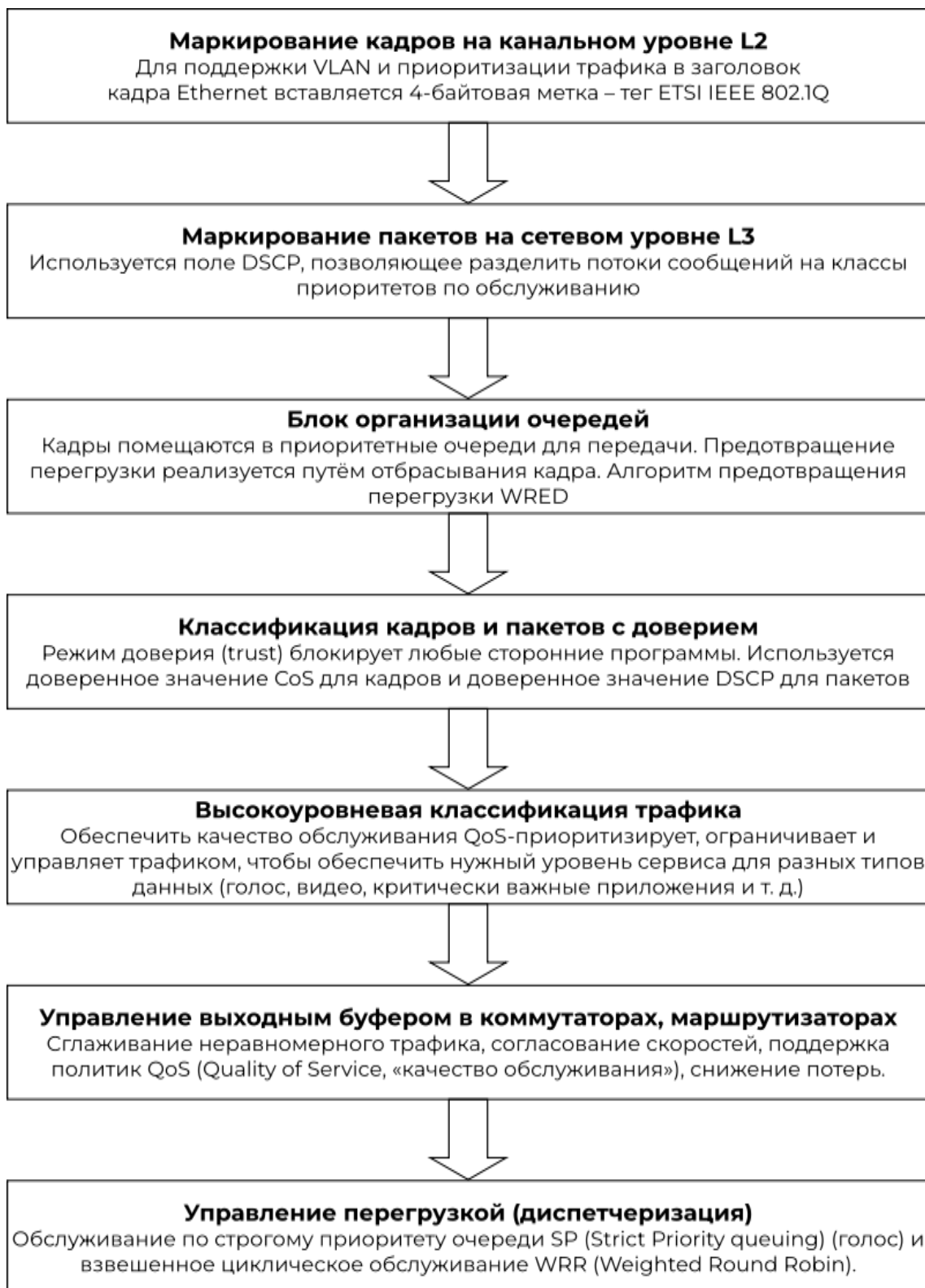
Рисунок 2.5 — Последовательность обслуживания пакетов информации в очередях коммутатора
