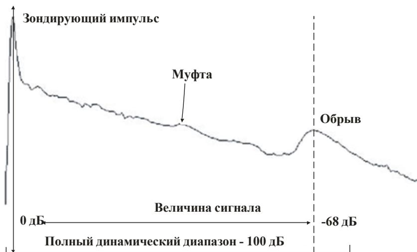
Рисунок 1.30 – Окно вейвлет-рефлектометра в логарифмическом масштабе
