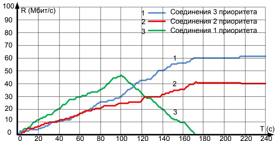
Рисунок 3.7 – Динамика работы алгоритма допуска в условиях перегрузки
