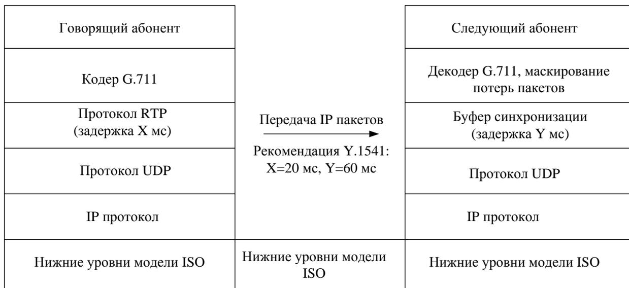
Рисунок 1.6 - Структура разговорного тракта в IP сети
