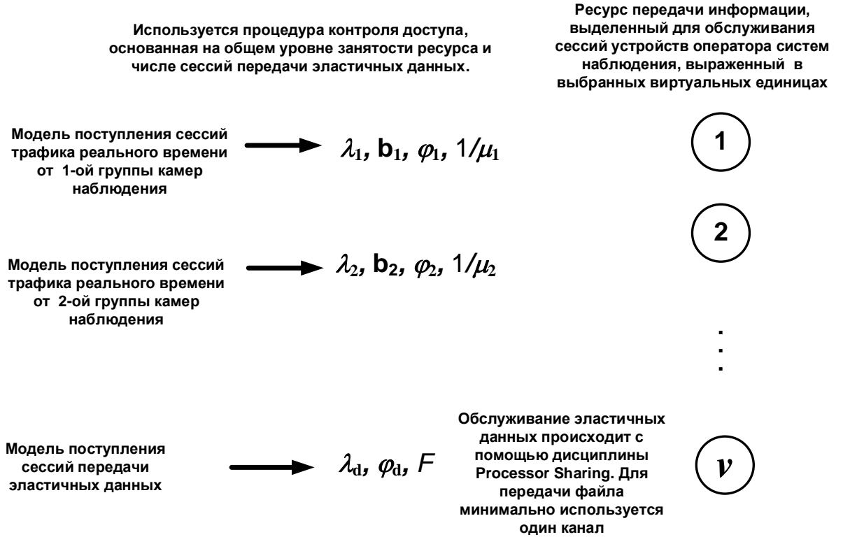
Рисунок 3.12 — Математическая модель использования ресурса соты сети LTE, выделенного для обслуживания сессий связи оператора систем наблюдения
