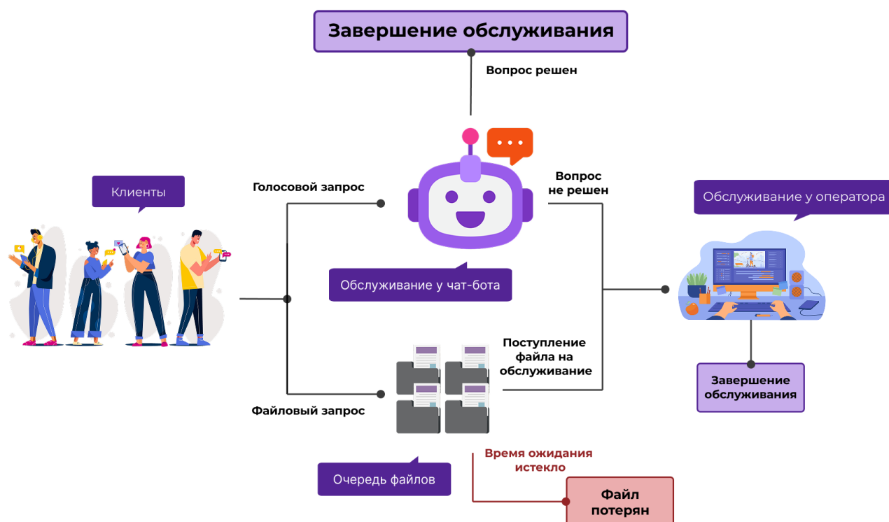
Рисунок 4.1 — Функциональная модель контакт-центра совместного обслуживания голосовых и файловых запросов
