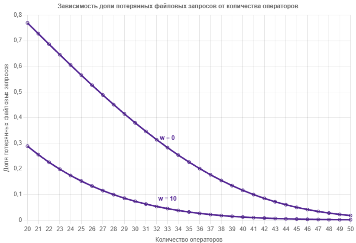
Рисунок 4.9 — Значения доли потерянных файловых запросов \pi_f с ростом числа операторов для разных сценариев обслуживания файлов
