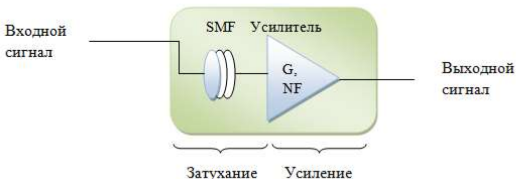
Рисунок 1.5 – Иллюстрация участка волокна с оптическим усилителем
