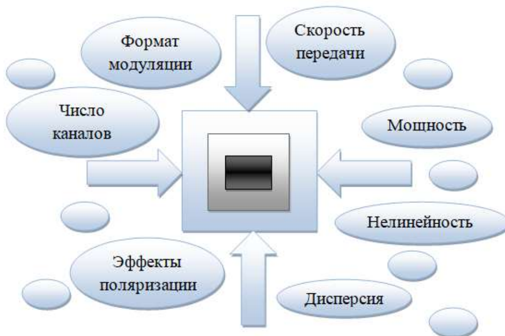
Рисунок 2.1 – Сжатие окна работоспособности при усложнении систем: 1 – скорость передачи; 2 – формат модуляции; 3 – мощность; 4 – нелинейность; 5 – дисперсия; 6 – эффекты поляризации; 7 – число каналов.
