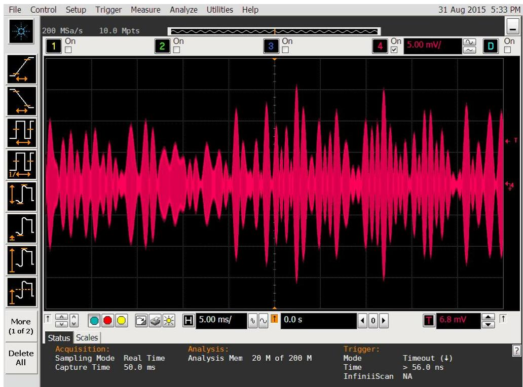
Рис. 54 Осциллограмма сигнала на выходе имитатора: несущая частота – 10 МГц; максимальная доплеровская частота – 1000 Гц.
