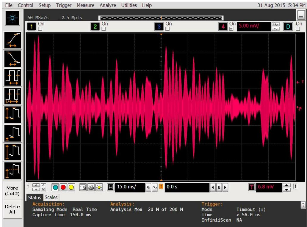
Рис. 53 Осциллограмма сигнала на выходе имитатора: несущая частота – 10 МГц; максимальная доплеровская частота – 300 Гц.
