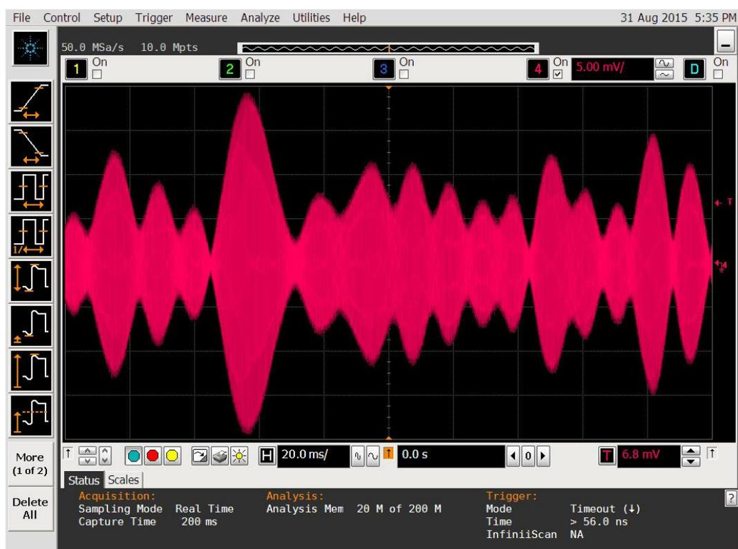
Рис. 52 Осциллограмма сигнала на выходе имитатора: несущая частота – 10 МГц; максимальная доплеровская частота – 50 Гц.
