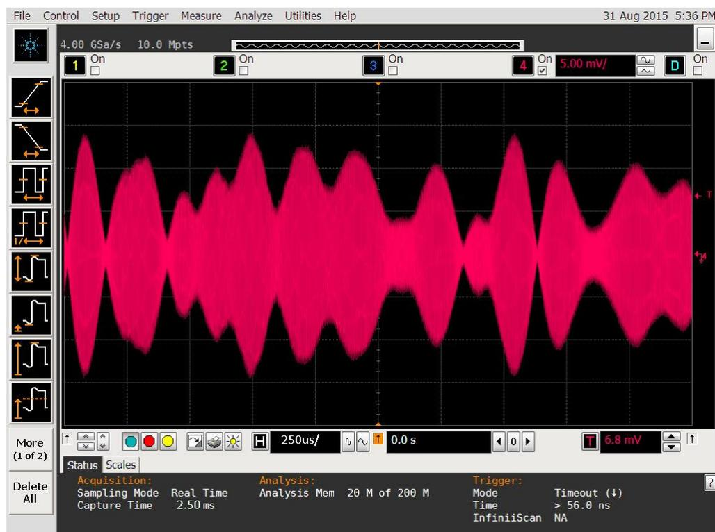
Рис. 55 Осциллограмма сигнала на выходе имитатора: несущая частота – 10 МГц; максимальная доплеровская частота – 50 Гц.
