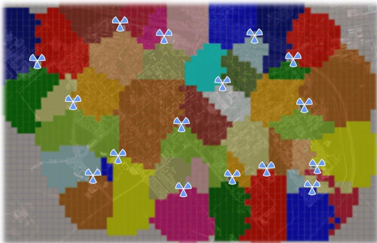
Рис. 3.16. Покрытие, обеспечиваемое совокупностью из 16 БС
